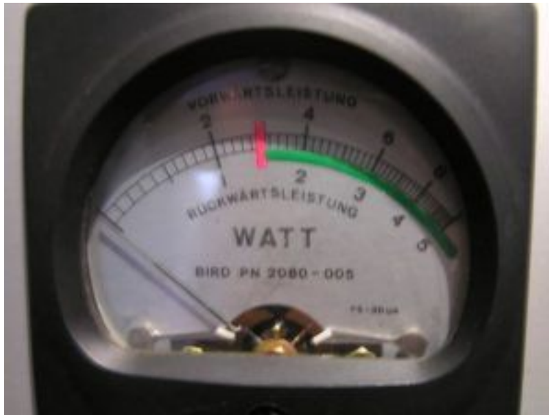
Ваттметр — прибор для измерения мощности
